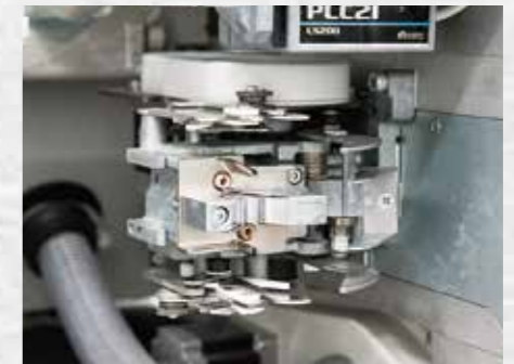
新开发的新型 CSY 空气捻接器解决了弹性面料服饰方面需求高涨的 Spandex (氨纶纤维) 的接线技术性课题。
