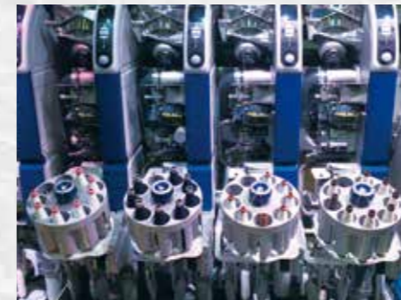
采用四种捻接器 (S.A.S. (新型 CSY 空气捻接器)、热捻接器、喷雾捻接器、通用空气捻接器) 进行捻接演示。
