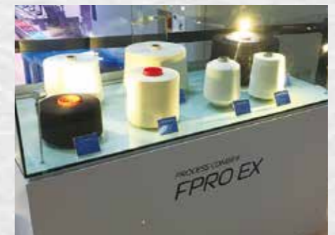
展出实现 4 英寸横动、蠕动系统、锥筒、端面修正等富宝络 EX 各种功能的卷绕筒纱。
