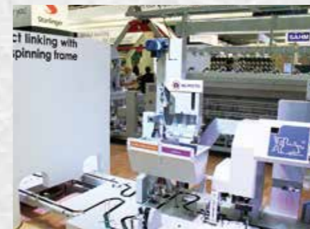
Bobbin Exchanger 能够去除和回收管纱品质原因排出的半管纱等不良纱管，实现机械效率的最大化。
